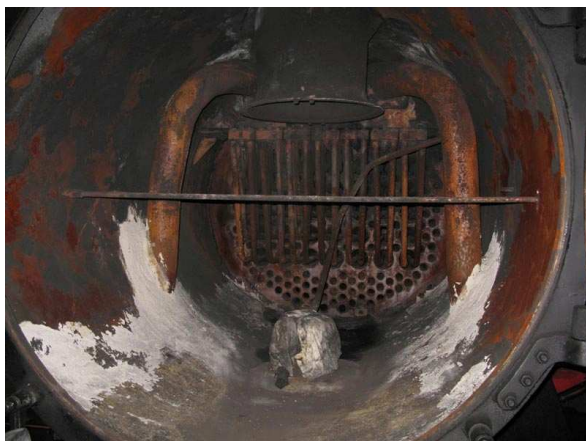
Lok 52 4867: Vorbereitungen in der Rauchkammer, erfolgreich absolvierter Drucktest
