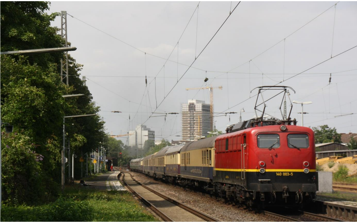
Die „Angstlok“ 140 003 musste selten eingreifen und diente lediglich der Stromversorgung, insbesondere der der Klimaanlage
