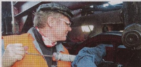
Zuwendung: Siegrid Zscherneck nutzt den Zwischenhalt, um den Antrieb der fast 80 Jahre alten Lokomotive zu ölen.
