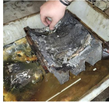
Reste des schadhaften Achslagers
